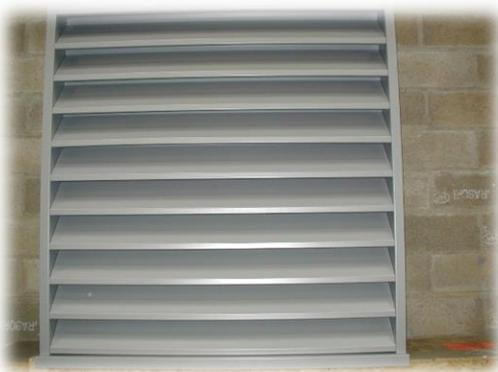
Persiennes fixes montées sur cadre aux dimensions souhaitées peuvent être utilisées pour de multiples applications. A partir de tôles prélaquées ep. 0,75 assemblées par rivets ou de tôles plus épaisses soudées, différentes conceptions sont possibles.
